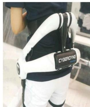
注1) 防水機能 IPX4 レベル(どのような方向からでも飛沫程度の水ならば、有害な影響を受けない。但し、水没しないこと。) 脱衣室での着脱介助、浴室内での直接介助、シャワー浴介助、一般浴介助などの通常の入浴介助場面にて使用可能。
